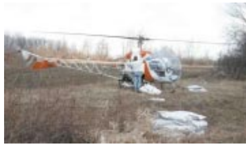
L'ÉPANDAGE AÉRIEN EST EFFECTUÉ PAR AVION OU PAR HÉLICOPTÈRE. LE PRODUIT, SOUS FORME GRANULAIRE, EST VERSÉ DANS LE RÉSERVOIR.
