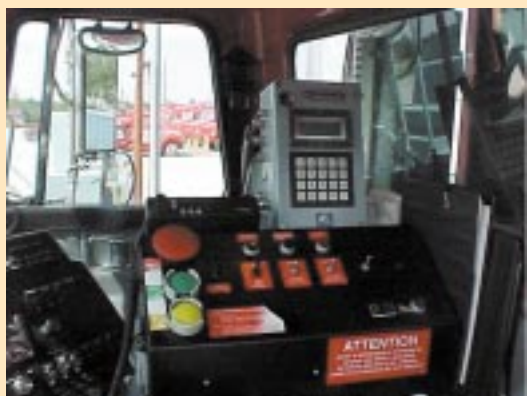
LA BALANCE DYNAMIK, MONTÉE SUR UN CAMION À CHARGEMENT AVANT, PERMET DE PESER LE CONTENU D'UN CONTENEUR DURANT LA LEVÉE (SAINTE-FOY, PHOTO DU HAUT) ET UN ORDINATEUR INSTALLÉ À L'INTÉRIEUR DU CAMION COMPILER TOUTES LES DONNÉES (PHOTO DU BAS).
