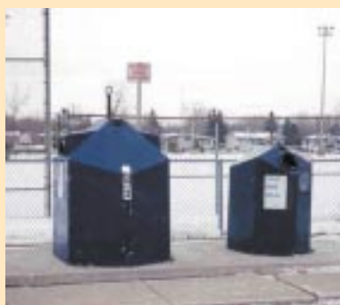
LES CLOCHES DE FIBRE DE VERRE (PHOTO DE GAUCHE À LAVAL) FRAGILES ET INFLAMMABLES SERONT DE PLUS EN PLUS REMPLACÉES PAR DES CLOCHES EN MÉTAL (PHOTO DU BAS EN MAURICIE)
